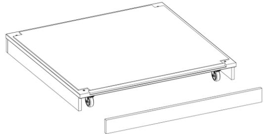
**IMPORTANT : Positionner le socle au futur emplacement de la cabine. A l'aide d'un niveau, s'assurer de la bonne planéité du sol. Dans le cas contraire, déplacer la cabine jusqu'à la positionner sur une zone parfaitement plane.**
