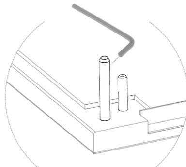
**IMPORTANT** : Positionner le socle au futur emplacement de la cabine. A l'aide d'un niveau, s'assurer de la bonne planéité du sol. Dans le cas contraire, utiliser les vérins de réglage afin de rendre le socle parfaitement plat.
