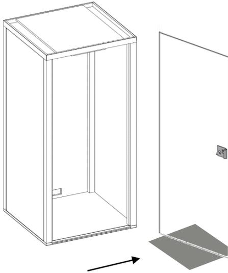
**IMPORTANT** : Veillez à ce que la porte soit positionnée dans le bon sens. S'assurer que vous placez bien l'autocollant **EXT** à l'extérieur de la cabine et l'autocollant **INT** à l'intérieur.
