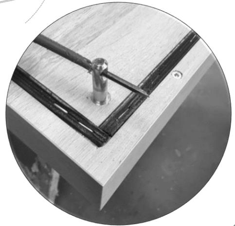
Positionner les **F** dans le socle. A l'aide d'un tournevis, verrouiller le **F**.
