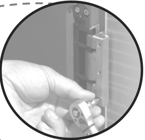
Engager la porte dans les charnières et serrer à l'aide d'une clé dynamométrique.
